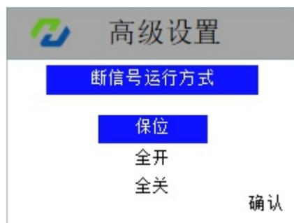
图40：总线断信号运行方式
