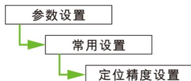
根据菜单路径导航进入到定位精度设置界面，通过按遥控器  $\uparrow$  键或  $\downarrow$  键，调整控制死区百分比参数，调整到想要设置的数值后，按  $\rightarrow$  键，确认保存参数。定位精度设置不得小于执行器的控制死区。
