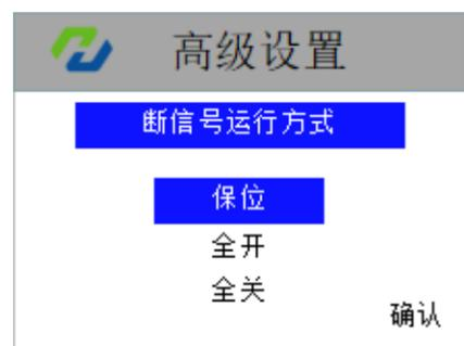
图23：模拟量断信号运行方式
