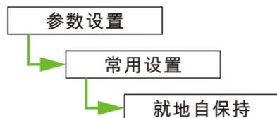
根据菜单路径导航进入到就地自保持设置界面，使用遥控器  $\uparrow$  键或  $\downarrow$  键，选择禁止或使用就地自保持功能，按  $\rightarrow$  键，确认保存参数设置。执行器默认设置禁用就地自保持，就地旋钮和遥控器开关阀为点动方式，使用该功能后，就地旋钮和遥控器开关阀为自保持方式。
