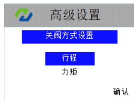
图32：关阀方式设置
