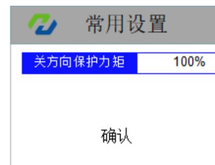
图53：设置关方向保护力矩
