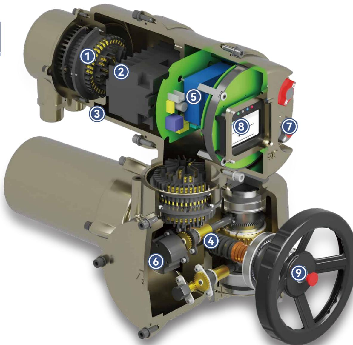
6 行程检测采用磁电式多圈绝对编码器，感应灵敏，精度高，断电不丢失阀位，最大4095圈
